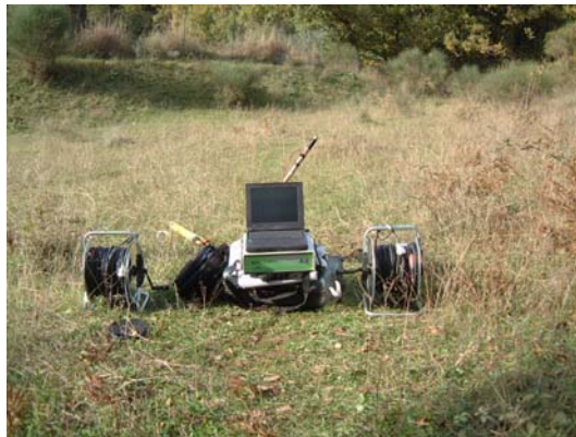
Sismografo 24 canali Ambrogeo mod. Echo 24/2002 Seismic UNIT.
